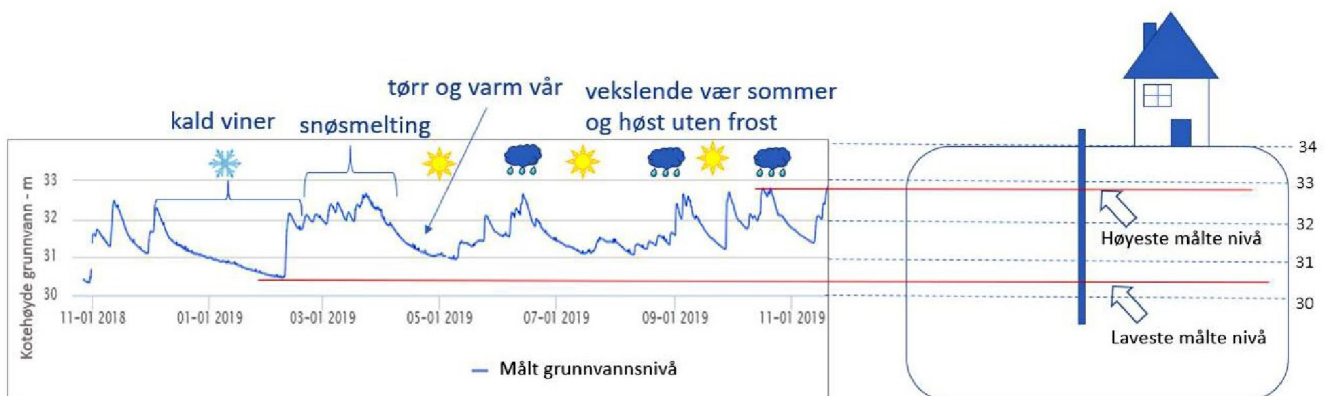
Figur 5.8. Variasjonen i grunnvannstand for et helt år fra en poretrykkmåler på Skøyen i Oslo. Måleren var installert i september 2018 på 6,5 meters dybde og viser poretrykkmålinger for hele 2019. Målingene er utført av Geonor på oppdrag fra Fornebubanen. (Illustrasjon: Figuren er satt sammen av Ingrid Mørck, VAV).
