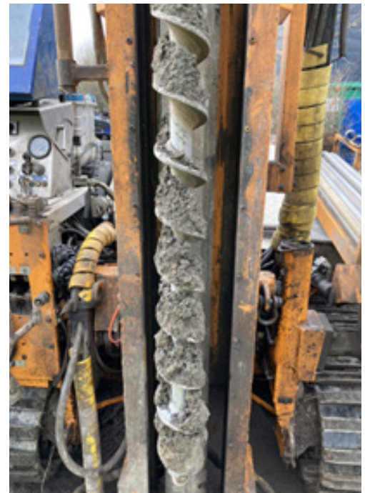
Figur 10 Geoteknisk rigg med augerboring.. (Foto: M. Tvedten, Asplan Viak)
